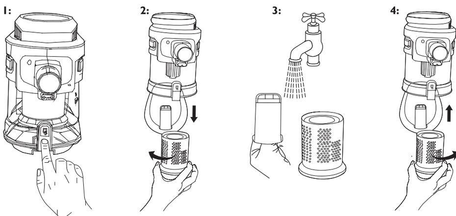
**Remarque:** Ne pas nettoyer le filtre HEPA à l'aide de détergents et ne pas utiliser de sources de chaleur extérieures comme un radiateur pour le sécher.
