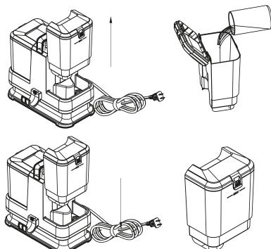
**KROK 1:** wyjmij zbiornik czystej wody, unosząc go z jednostki głównej urządzenia.
