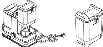
**SCHITT 1:** Entfernen Sie den Tank für sauberes Wasser, indem Sie ihn weg von der Haupteinheit des Fleckenreinigers anheben.
