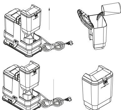
**PASSO 1:** retire o depósito de água limpa, levantando-o da unidade principal do aparelho de limpeza de manchas.
