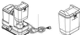
**PASO 1:** Retire el depósito de agua limpia levantándolo para extraerlo de la unidad principal del limpiador de manchas.
