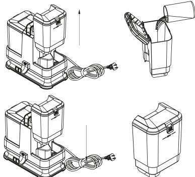
**PASSAGGIO 1:** Rimuovere il serbatoio dell'acqua pulita sollevandolo dall'unità principale del pulitore portatile.
