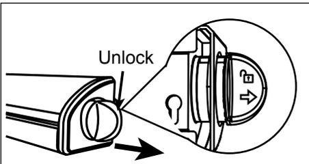
**SCHRITT 8:** Drehen Sie den Verriegelungsmechanismus (6) im Uhrzeigersinn, um die Leinen vollständig festzuziehen, und drücken Sie dann den seitlichen Verriegelungsmechanismus hinein, um ihn zu fixieren.
