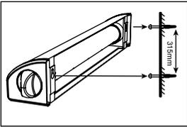
**SCHRITT 5:** Montieren Sie die Befestigungshaken (4), indem Sie vier Löcher auf eine geeignete Fläche gegenüber der einziehbaren Wäscheleine setzen. Achten Sie dabei darauf, dass der Abstand nicht mehr als ca. 4 m beträgt. Die Befestigungshaken müssen auf der gleichen Höhe wie die Waschschiene (5) montiert werden und sicherstellen, dass die Bohrungen an den Befestigungshakenbohrungen ausgerichtet sind.
