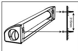
**ÉTAPE 5 :** installez les crochets de fixation (4) en perçant quatre trous dans une surface adaptée en face du fil à linge rétractable, en vérifiant que la distance qui les sépare ne dépasse pas 4 mètres environ. Les crochets de fixation doivent être installés à la même hauteur que la barre de fil à linge (5). Vérifiez que les trous percés sont alignés avec les trous des crochets de fixation.
