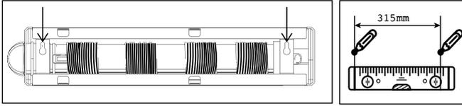
**STAP 3:** Steek een wandplug (2) in elk gat en bevestig deze met de schroeven (3). Zorg ervoor dat de schroefkop ver genoeg uit de wand steekt.
