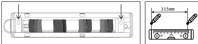
**KROK 3:** włóż kołek ścienny (2) do każdego otworu, po czym przymocuj za pomocą śrub (3), upewniając się, że główka śruby wystaje ze ściany na odpowiednią długość.
