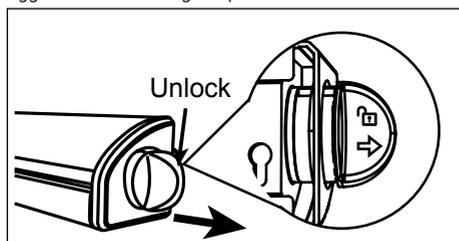
**PASSAGGIO 8:** ruotare il sistema di bloccaggio (6) in senso orario per tendere bene i fili, quindi spingere il sistema di bloccaggio verso l'interno per fissarlo in posizione.
