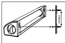
**PASSAGGIO 5:** fissare i ganci di fissaggio praticando quattro fori su una superficie idonea sul lato opposto a quello del filo stendibiancheria riavvolgibile, dopo aver verificato che la distanza tra i due punti non sia superiore a 4 metri circa. I ganci vanno montati alla stessa altezza della barra stendibiancheria (5) e i fori devono combaciare perfettamente con quelli dei ganci.
