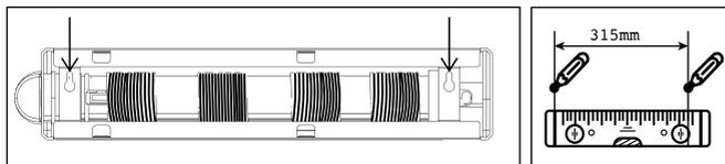
**ÉTAPE 3 :** insérez une cheville (2) dans chaque trou, puis fixez-les à l'aide des vis (3) en vous assurant qu'une portion suffisamment longue des têtes de vis sorte du mur.
