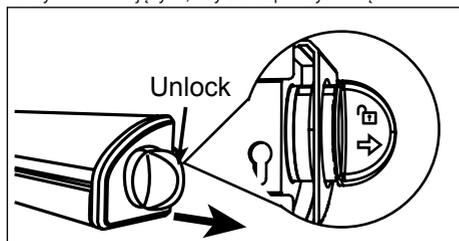
**KROK 8:** przekręć mechanizm blokujący (6) zgodnie z ruchem wskazówek zegara, aby całkowicie naciągnąć linki, a następnie wcisnij boczny mechanizm blokujący, aby je zabezpieczyć.
