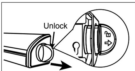
**PASO 8:** Gire el mecanismo de bloqueo (6) en el sentido de las agujas del reloj para tensar las cuerdas y pulse el mecanismo de bloqueo lateral para fijarlo en su sitio.
