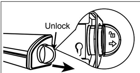
**STAP 8:** Draai het vergrendelmechanisme (6) rechtsom om de lijnen volledig vast te zetten en druk vervolgens het vergrendelmechanisme aan de zijkant in om het op zijn plaats vast te zetten.
