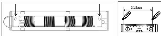
**PASSAGGIO 3:** inserire un tappo a muro (2) in ciascun foro, quindi fissarlo in posizione utilizzando le viti (3) assicurandosi che la testa della vite sporga dalla parete per una lunghezza sufficiente.
