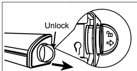
**ÉTAPE 8 :** tournez le mécanisme de verrouillage (6) dans le sens des aiguilles d'une montre pour serrer complètement les fils, puis appuyez sur le mécanisme de verrouillage latéral pour les fixer.
