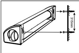
**STAP 5:** Installeer de bevestigingshaken (4) door vier gaten te maken op een geschikt oppervlak tegenover de uittrekbare waslijn en controleer of ze niet verder dan ongeveer 4 meter uit elkaar staan. De bevestigingshaken moeten op dezelfde hoogte worden gemonteerd als de waslijnstang (5). Zorg ervoor dat de gaten op één lijn liggen met de gaten van de bevestigingshaken.
