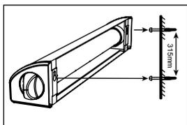
**KROK 5:** przymocuj haki mocujące (4), wykonując cztery otwory na odpowiedniej powierzchni naprzeciwko zwijanej linki. Sprawdź, czy odległość między nimi nie przekracza ok. 4 metrów. Haki mocujące muszą być zamontowane na tej samej wysokości co drążek linki na pranie (5). Upewnij się, że wykonane otwory są wyrównane z otworami haków mocujących.
